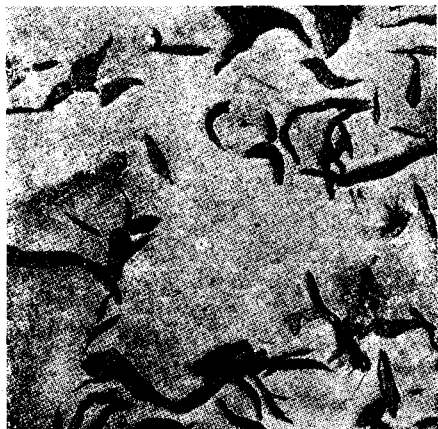
Фиг. 464. Немагнитный чугун (аустенитовое литье).
