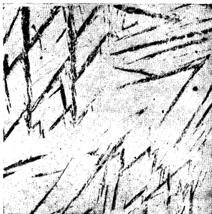
Пикриновая кислота × 50 Фиг. 99. Аустенит (светлый) + переходная структура (темная); последняя, часто обозначается как мартенсит.
