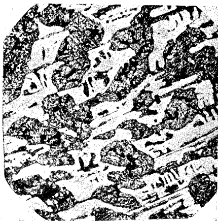
Пикриновая кислота × 50 Фиг. 104. Закаленный железо-углеродистый сплав с 3,6% С. Белые поля — цементит. Черные узелки — троостит. Основа — смесь аустенита и мартенсита (ср. фиг. 105).
