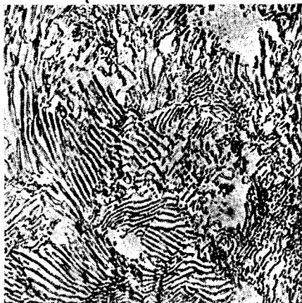
Пикриновая кислота × 500 Фиг. 223. Медленно охлажденная сталь с 0,7% углерода. Феррит — светлый. Перлит — тонкая смесь пластинок феррита и цементита. Последние противостоят действию пикриновой кислоты и остаются в рельефе.
