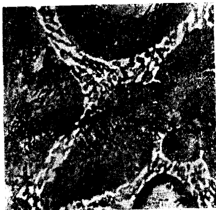
Пикриловая кислота \times 500 Фиг. 478. Тот же чугун, что на фиг. 477, но отожженный при 900° в течение 2 часов. Коагуляция фосфида.
