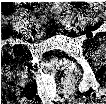
Пикриновая кислота \times 500 Фиг. 477. Литейный чугун (2,32% С, 1,93% Mn, 0,80% P), с фосфидной эвтектикой, неотожженный.
