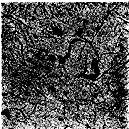
Не протравлено \times 50 Фиг. 468. Серое литье, отливка в горячую форму, медленное охлаждение.
