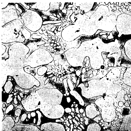
Щелочн. раствор пикрата натрия \times 75 Фиг. 226. Чугун с 3,6% углерода. Цементит ( \text{Fe}_3\text{C} ) окрасился в темный цвет под действием пикрата натрия.
