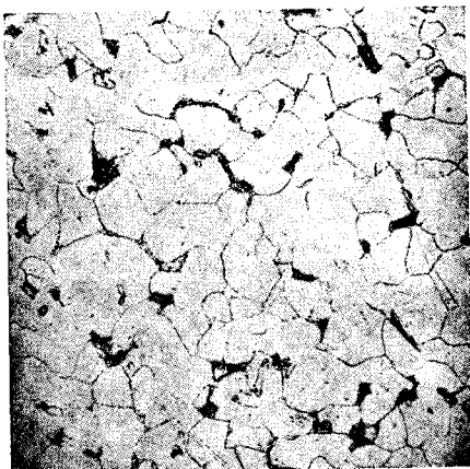
Пикриновая кислота ×100 Фиг. 418. Углерод = 0,08%.
