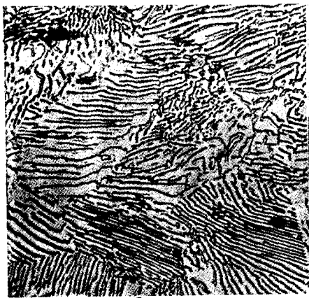
Пикриновая кислота ×600 Фиг. 354. Сталь с 0,88% С. Пластинчатый перлит.
