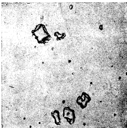
Не протравлено ×100 Фиг. 295. Включения нитрида титана.
