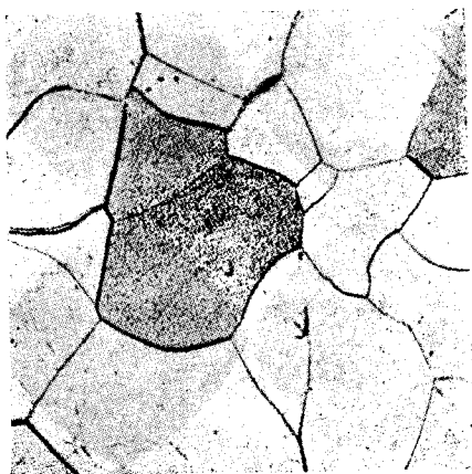
Пикриновая кислота × 50 Фиг. 219. Травящее действие пикриновой кислоты. Материал состоит только из одной структурной составляющей — феррита — в форме неправильных многоугольников. Освещенные и затененные края указывают на то, что отдельные кристаллические зерна протравились скорее остальных.
