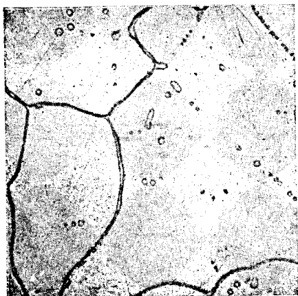
Не протравлено × 100 Фиг. 287. Никель, содержащий всего 0,18% серы. Несмотря на низкое содержание серы, образуется хрупкая сетка сернистого никеля.
