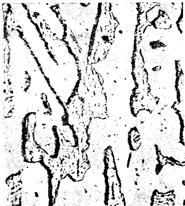
Пикриновая кислота × 300 Фиг. 217. Действие травления. В рельефе — различимый по освещенным и затененным краям цементит, не разъединенный протравой. Глубже лежит разъединенный протравой феррит.
