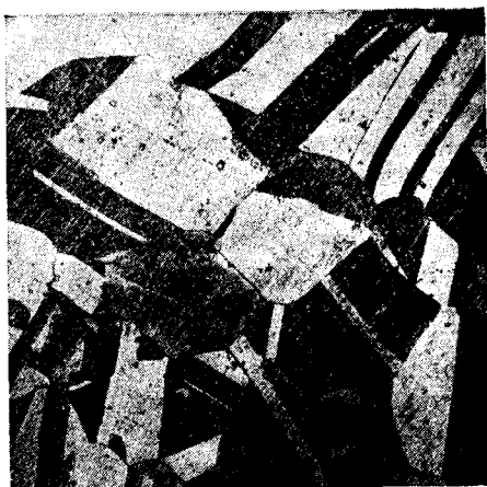
\text{FeCl}_3 + \text{HCl} \times 300 Фиг. 17. Латунь с 20% Zn, отожженная. \alpha -полиэдры.
